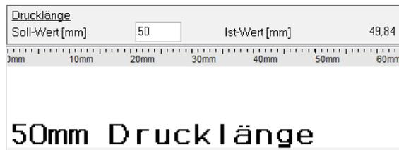
Neben dem Soll-Wert wird auch der Ist-Wert angezeigt, der für den aktuell gewählten Drucker mit dem verwendeten Drehgeber jeweils neu berechnet wird.
