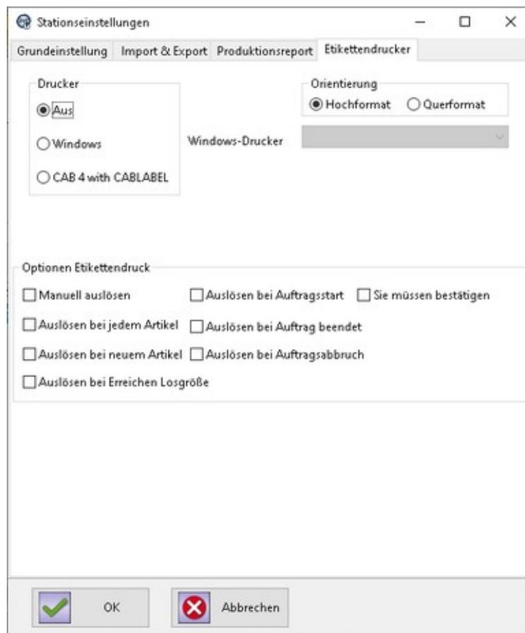
Diese Einstellungen beziehen sich auf einen separaten Etikettendrucker, der ein Etikett beispielsweise bei Erreichen einer bestimmten Losgröße druckt, z.B. für Versand, Sortierung etc.
