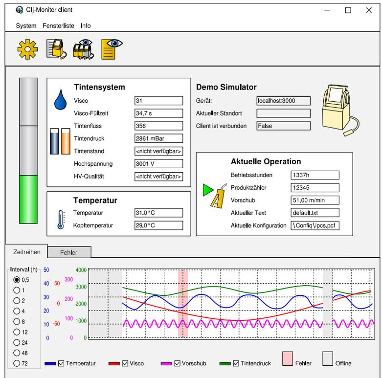
Druckerzustand aus der Detailansicht und zeitlicher Verlauf ausgewählter Druckerparameter
